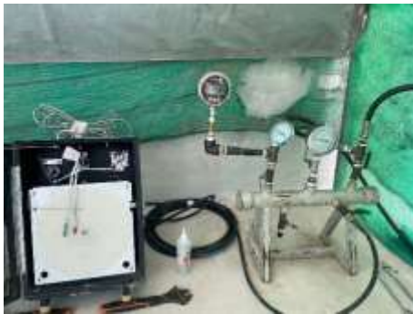
ภาพที่ 3-1 การทดสอบการรั่วไหลของท่อด้วยวิธีการทดสอบแบบอัดอากาศ (Air Pressure Test)
